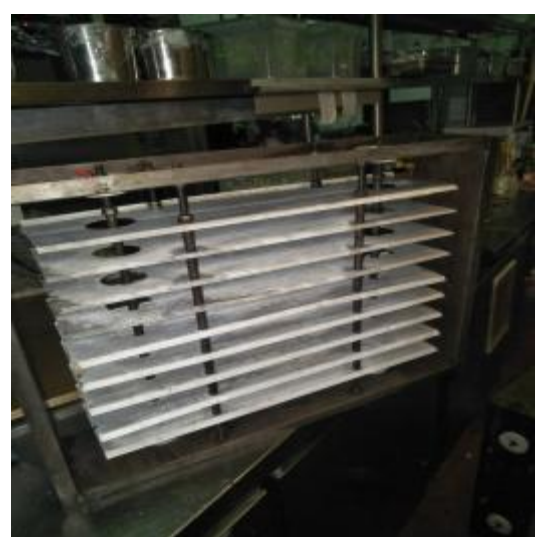
38 楼净化器清洗后
