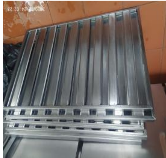
防火板清洗后
