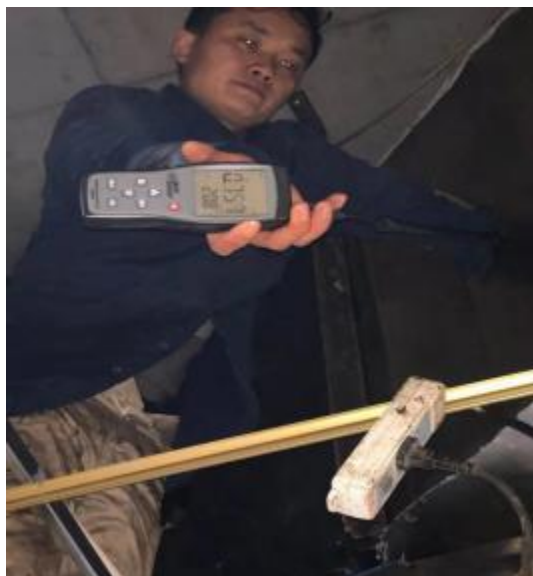
中厨房清洗前后风速测试
