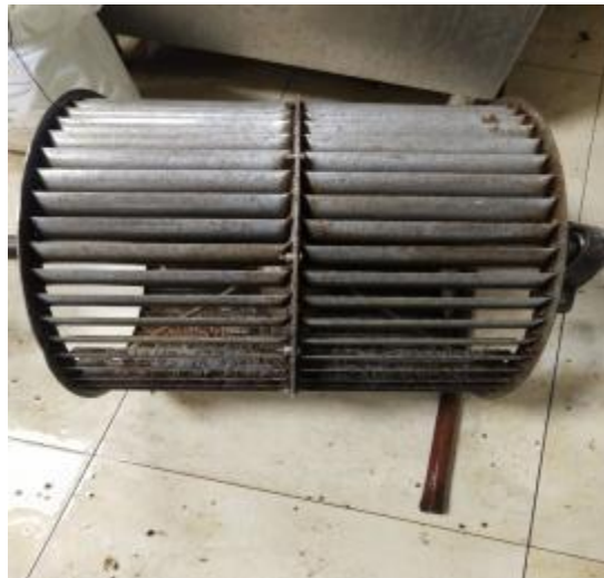
风机叶片清洗后
